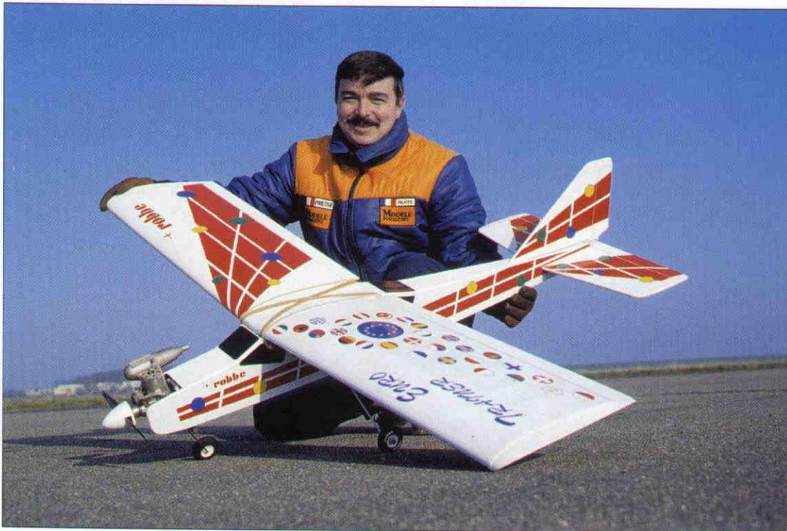
Les avions possédant des ailerons pour contrôle de l'axe de roulis sont nommés "3-axes", ce qui est le cas de ce typique avion de début à aile haute de formes simples.
