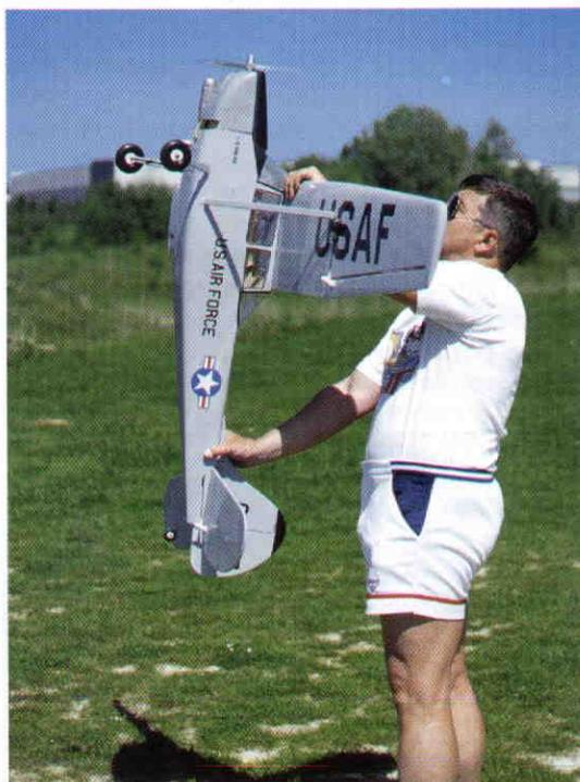
**Pour piloter sans stress, il faut un moteur bien réglé qui ne cale pas au ralenti et tient un régime élevé stable, ce qui s'obtient en cherchant la pointe (régime maxi) nez de l'avion en l'air.**
