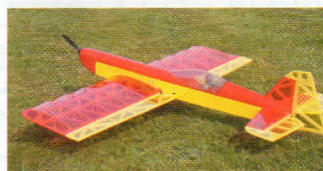
Les avions de voltige 3D ont des ailes à faible allongement.
