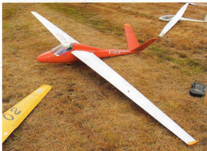
Les planeurs utilisent des voilures à grand allongement.
