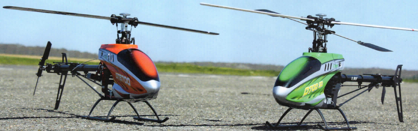
Certaines marques proposent parfois dans leur catalogue des machines identiques au niveau cellule déclinées en deux versions «Flybarless» (L'Esky DTS 700 à gauche sur la photo) ou «Flybar». (L'Esky D7003D à droite)
